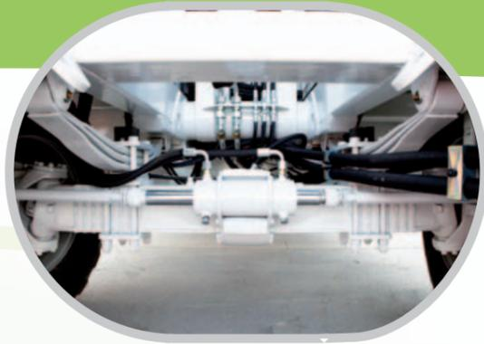
La máquina viene de serie con suspensión delantera por ballestas que asegura el máximo confort del operador en terrenos accidentados; opcionalmente pueden ponerse también ballestas sobre el eje trasero.
