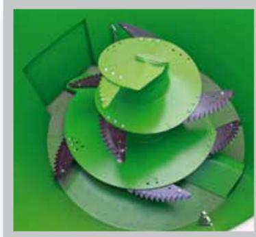
Sinfín equipado con cuchillas dentadas de alta resistencia.
