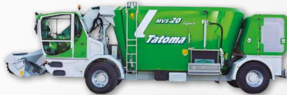
El sentido de rotación de la fresa es reversible gracias a dos pedales de accionamiento eléctrico que nos permite un control de la carga más preciso ya que podemos detener la carga y revertir el producto cuando se alcanza la cantidad requerida.
