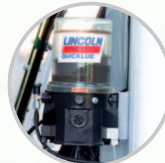
Graissage centralisé avec pompe (automatique)
