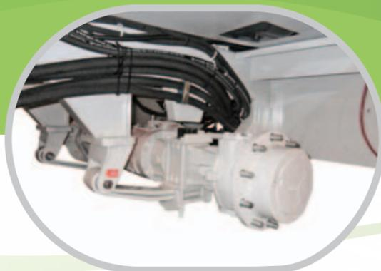
La machine est équipée de série avec une suspension avant à lames de ressorts qui assure un confort maximum de l'opérateur sur terrain accidenté, en option il est possible de monter aussi des lames de ressorts sur l'essieu arrière.
