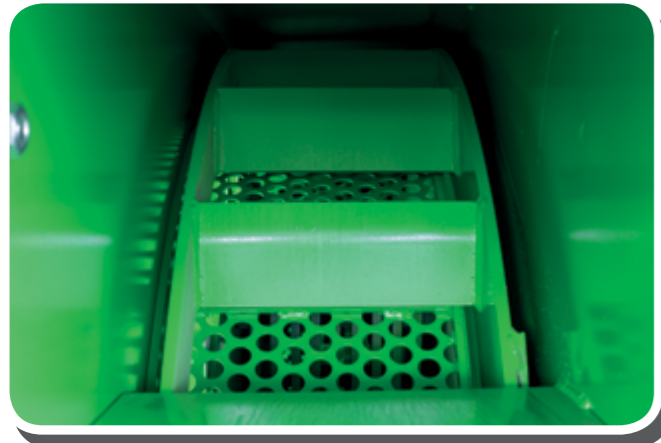
Detail grille Ø 2,5-3 cm. et marteaux de coupage (vue intérieure)
