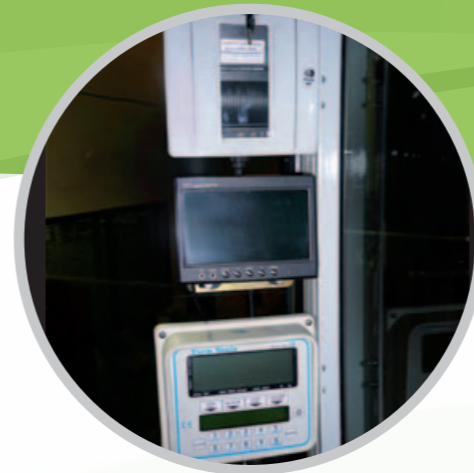
Système programmable de poids. Caméra surveillance et imprimante en option
